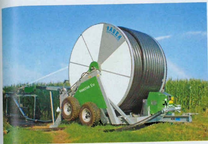
Große Anlagen erreichen Rohrlängen von bis zu 750 m. Eine Wasserturbine rollt den Schlauch über ein Getriebe wieder auf.
